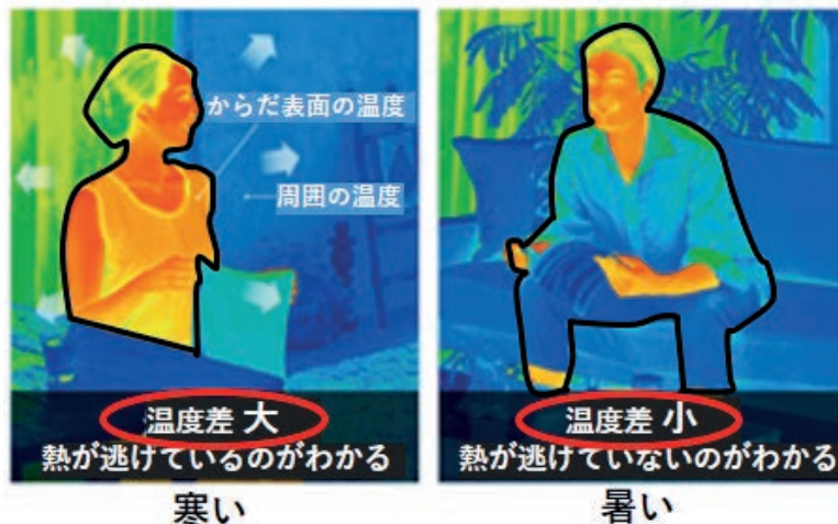
図1：放熱量に基づく温冷感推定原理説明
