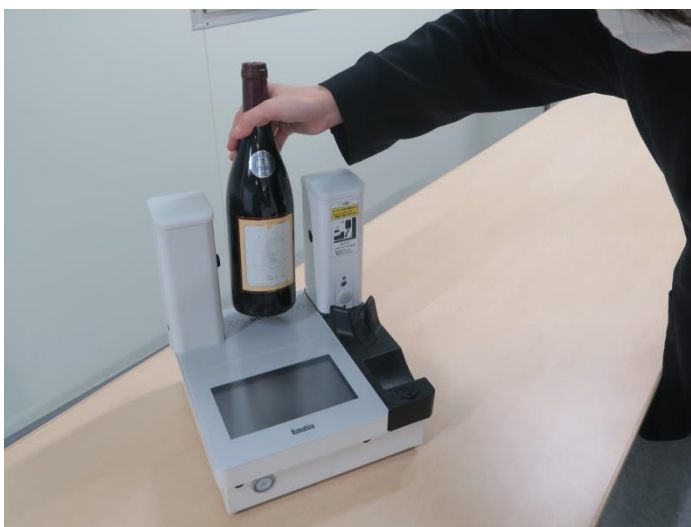
図 4 近赤外光スペクトルを用いた液体爆発物検査
