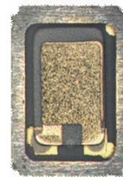
図2 水晶振動子の写真（開封後）
