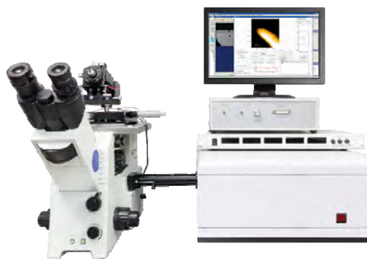
図 3 当社が製品化した高速 AFM 装置
