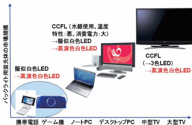
図1. 液晶ディスプレイ用バックライトの現状と今後
