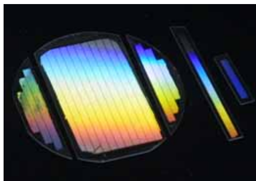
図4 .開発した欠陥制御単結晶基板（3インチ径）を波長変換素子へ加工。これから切り出して図5のようなデバイスを作成。
