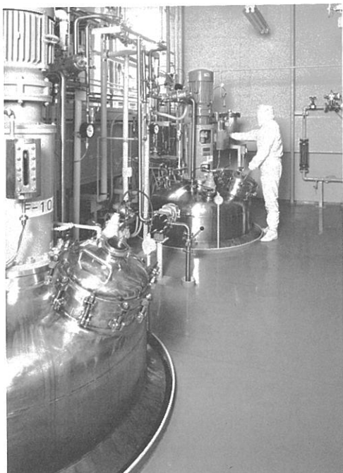
図2. 表面抗原を生産する組換え酵母の大量培養プラント
