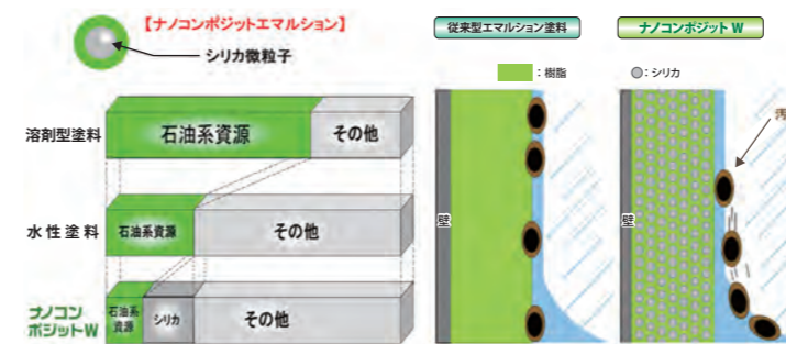
(左) 塗料中の組成物比較、(右) 塗膜耐汚染性向上の仕組み
