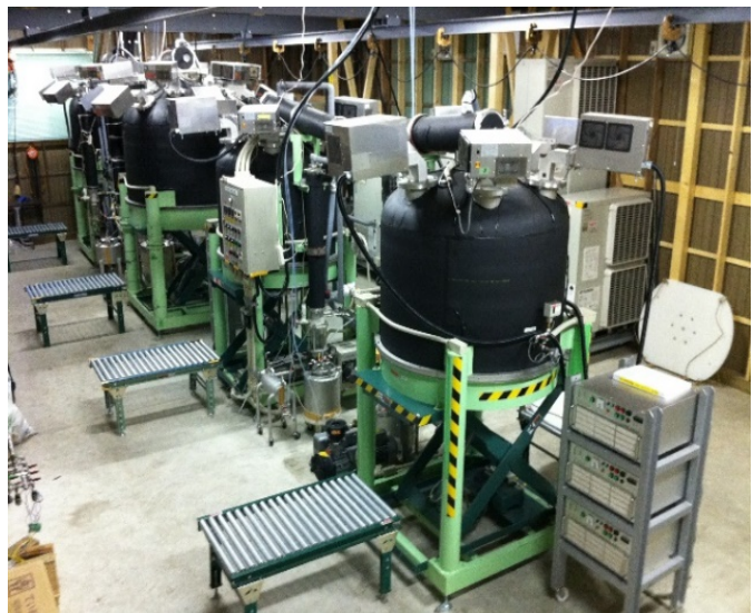
図2：マイクロ波減圧コントロール抽出装置
