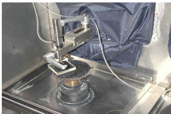
図-2 オスカー式研磨機(上)と研磨加工部(下)
