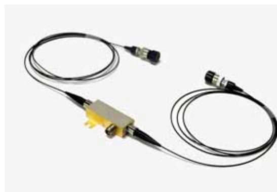
図 2 . 導波路型光周波数コム発生器の外観
